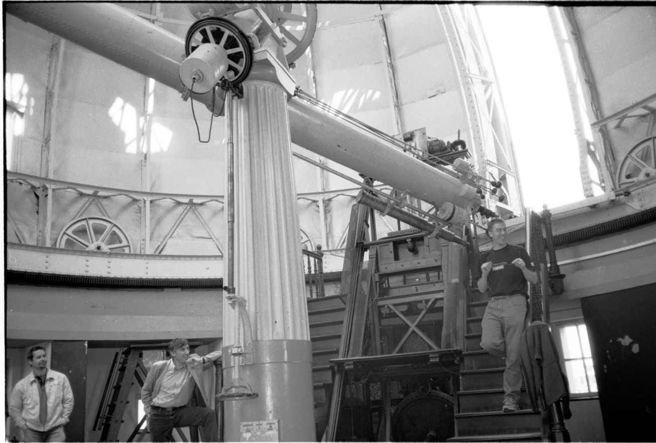
Grande lunette de l'observatoire de Strasbourg : f = 7 \text{ m} , D=49\text{cm} (W.Fortin 2005)
